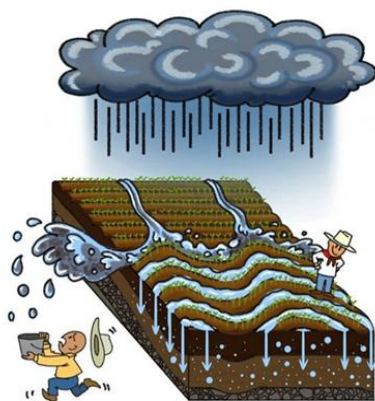
Figure 26 : Illustration du keyline design (à gauche ; Del Carmen Ponce-Rodríguez et al. (2021)) et exemple d'aménagement en fossé-buttée (à droite ; © Boris Hallier). F = fossé ; K = ligne de keyline avec plantation d'arbres ; A = zone en aval.
