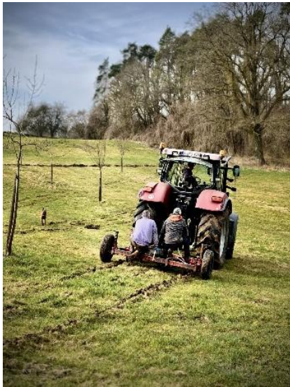
Figure 29 : Fissuration avec sous-soleuse en dents paraboliques/type Yeomans (à gauche ; © Fabian Feraux) et illustration des effets du sous-solage sur le sol et la végétation (à droite ; Mollison, 1988).
