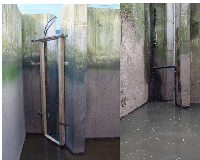
Figure 7 : Antenne de détection RFID au niveau d'une échancrure à l'amont de l'échelle à poissons du barrage des Grosses Battes sur la basse Ourthe à Liège (amont à gauche, aval à droite).
