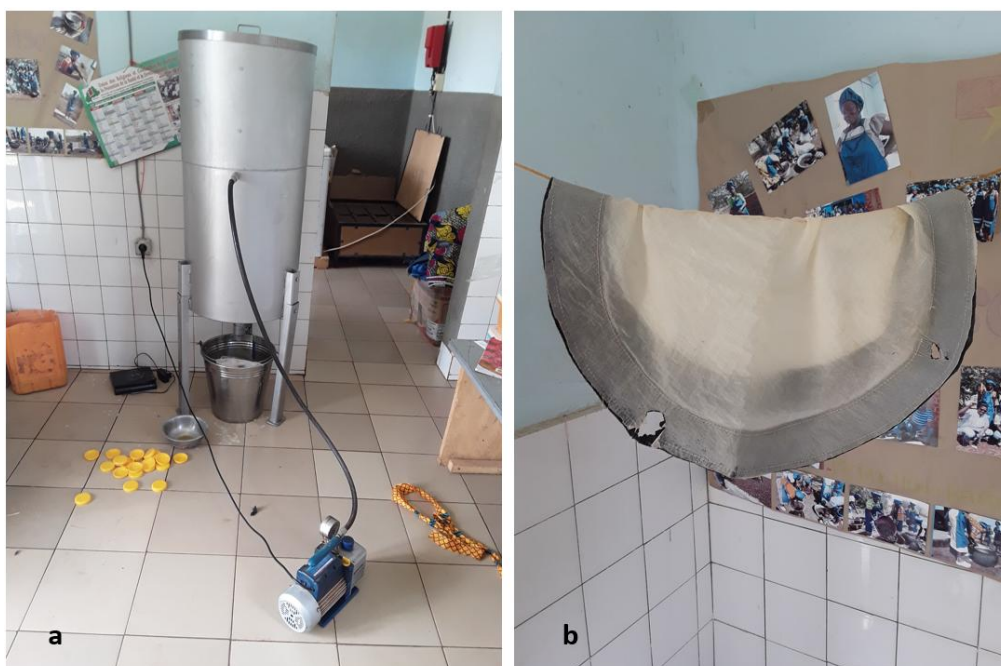
Figure 18: a) Dispositif de filtration à pompe de beurre de karité ; b) Tissu-filtre. Crédit photos : Bertrand Gombri
