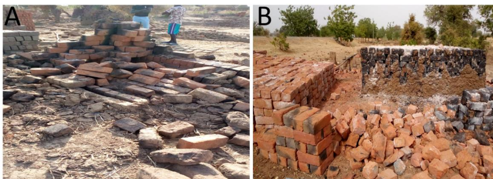
Figure 5.3 : Aperçu des briques mal cuites après défournement à Yagoua (Image A) et Pitoa (B). Source : Idrissou Mounpe, Enquête de terrain, Yagoua, mai 2022 et Pitoa, mai 2021.
