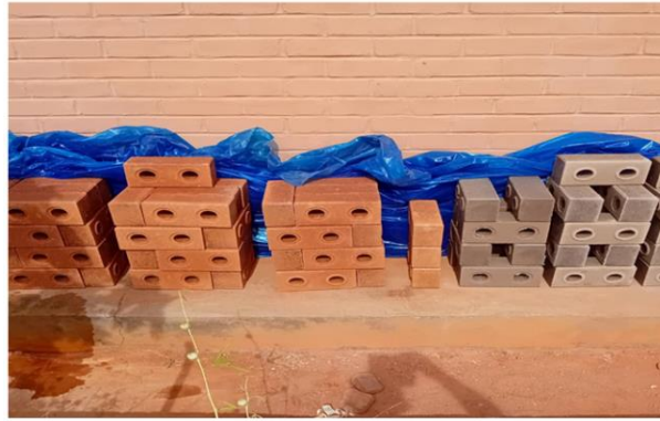
Figure 6.3 : Aperçu des briques stabilisées à la chaux, pressées au Centre Régional de la MIPROMALO pour le Nord à Garoua. Source : Achille Balo, novembre 2025.
