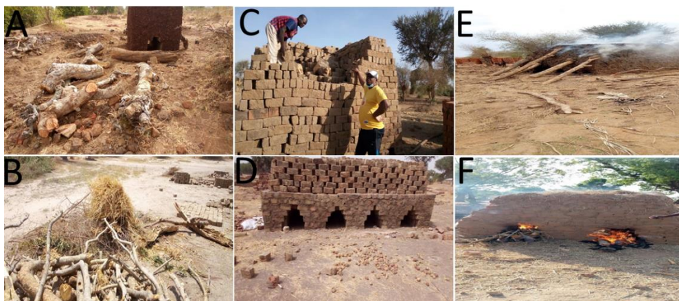
Figure 3.6 : Images de collecte du bois (A et B) ; de montage du four (C et D) puis du four allumé (E et F) Préparation de la cuisson des briques, aperçu de quelques combustibles (A, B, C et D). Source : Idrissou Mounpe, Enquête de terrain, Yagoua, avril 2022.
