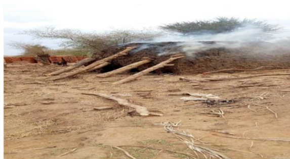
Figure 5.7 : Un four au début de la cuisson. Source : Idrissou Mounpe, Enquête de terrain, Yagoua, avril 2022.
