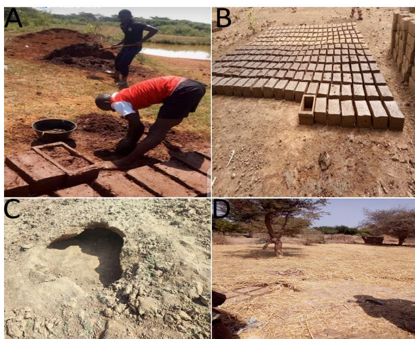
Figure 3.5 : Images du moulage (A) et démoulage (B) à Pitoa ; puis d'une mini-carrière de ravitaillement en sable en vue de revêtir les espaces nécessaires au moulage des briques (C) et de séchage (D) à Yagoua. Source : Idrissou Mounpe. Enquête de terrain d'avril 2022 à Pitoa et mars 2023 à Yagoua.
