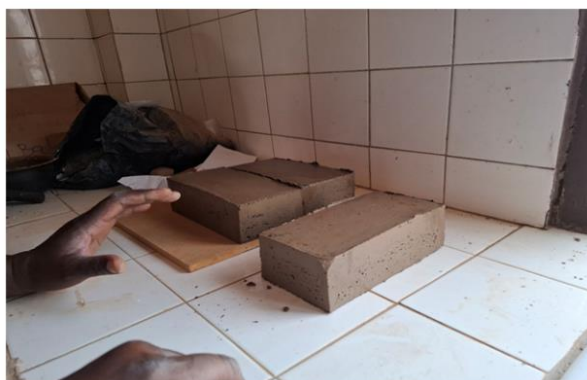
Figure 6.1 : Aperçu de la brique de terre stabilisée à la chaux fabriquée à l'aide d'un moule métallique. Source : Idrissou Mounpe, Atelier de formation des producteurs de brique de terre cuite à la production des briques de terre stabilisées à la chaux, Garoua ; 28 février 2025.
