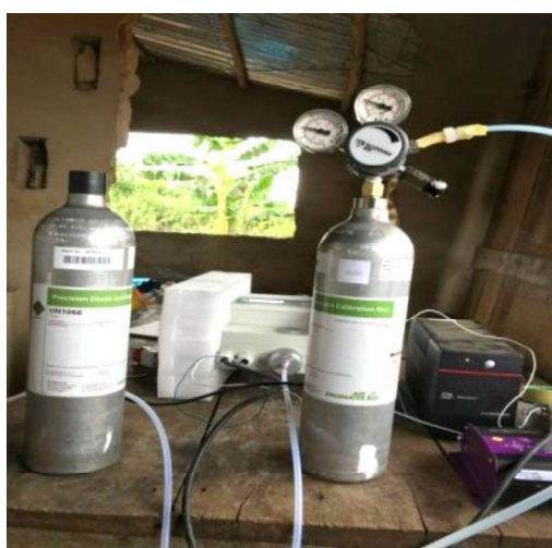
Figure 37 : Dispositif technique de mesure de \text{CH}_4 (© E. Gninkplékpo)
