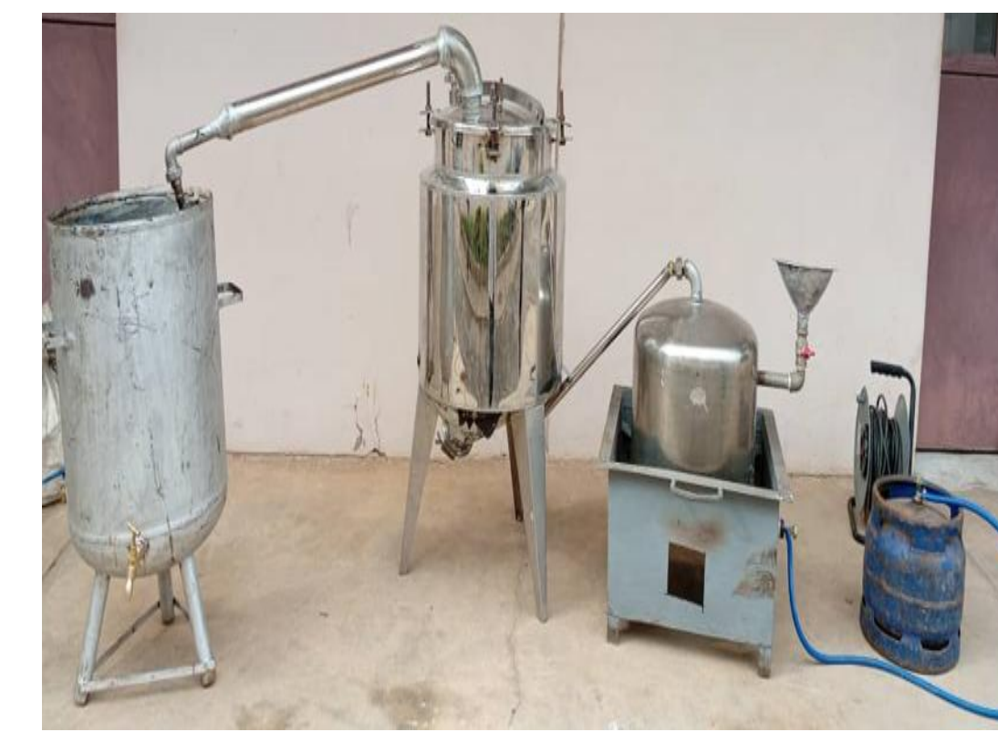
Technique l'extraction à la vapeur d'eau des feuilles d' Hyptis suaveolens
