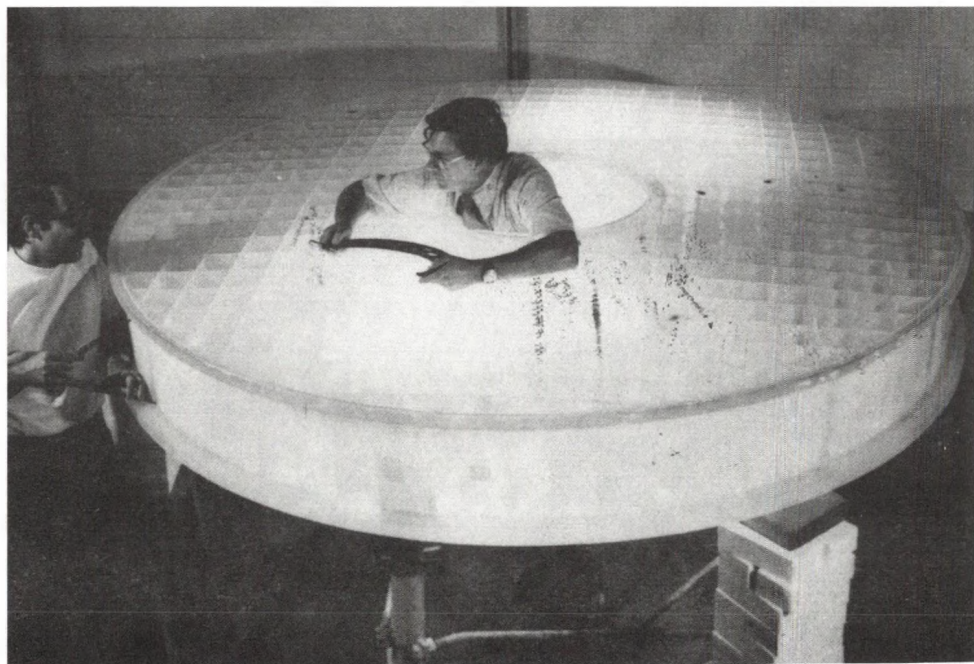
Le miroir principal du HST est examiné par des techniciens. On remarque la structure alvéolée qui permet de réduire la masse totale tout en maintenant une rigidité suffisante.
