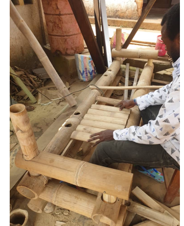
Assemblage par l'encadreur, des éléments en bambou destinés au montage du fauteuil.
