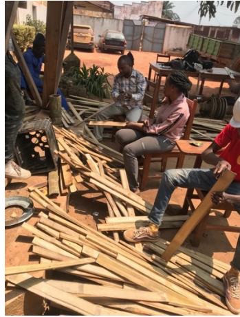
Ponçage manuel par les étudiants M1 et de l'ISP, des lattes de bambou.
