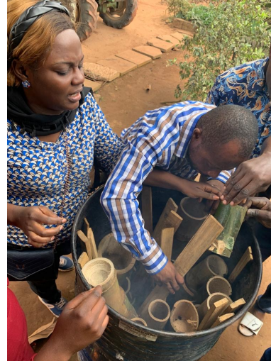
Classement des éléments en bambou dans un four destiné au traitement par fumigation.
