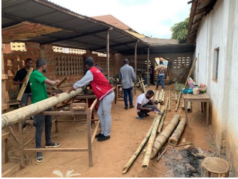
Découpage manuel avec la scie par les étudiants M1, des chaumes de bambou en rondelles destinées aux parois.
