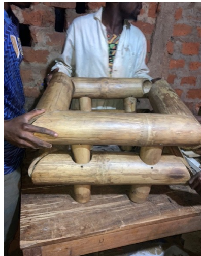
Assemblage par les étudiants M1 et encadreur, des éléments en bambou pour le montage de la table.
