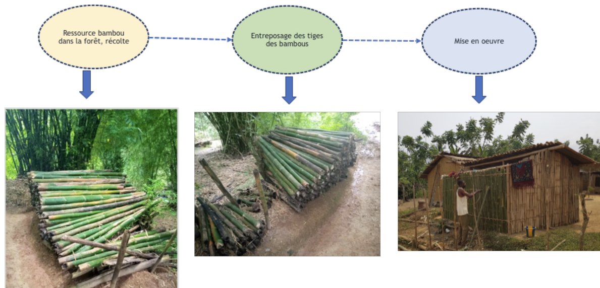
ILLUSTRATION. 3 . Entreposage des bambous dans la forêt ; mise en œuvre des bambou. Février - Mars 2020. Photographie de l’auteur.
