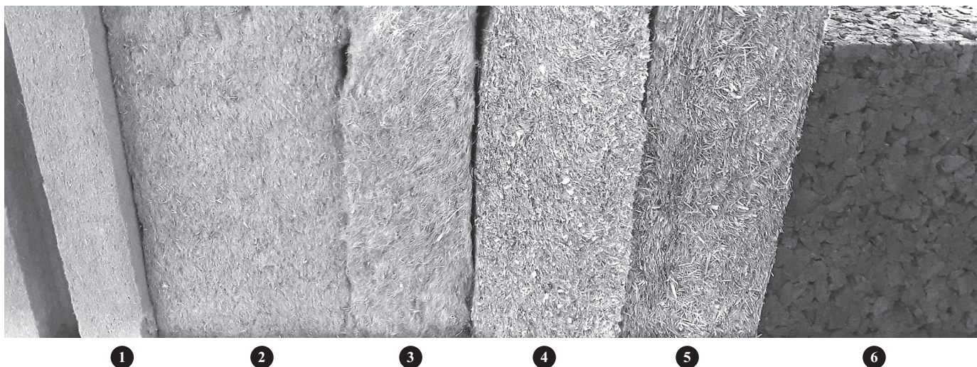
▲ Photo 6. Isolants biosourcés sous forme de matelas semi-rigides et panneaux rigides : (1, 2) fibres de bois, (3) fibres de chanvre, (4) fibres de cellulose, (5) fibres d'herbe et (6) liège expansé (source : S. Trachte).
