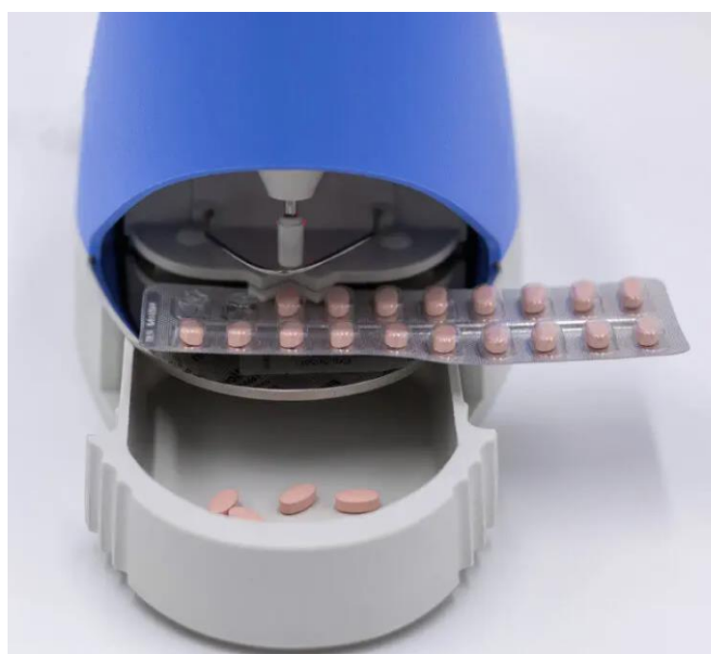
Figure 134 : Exemple de déblistéreuse semi-automatique à poinçon : Professional Poppitt[166].
