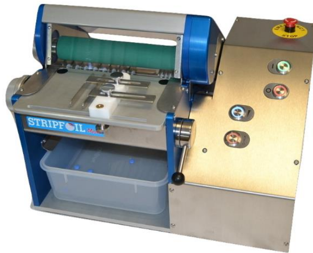
Figure 136 : Exemple de déblistéreuse semi-automatique à rouleau : Stripfoil Moto[168].
