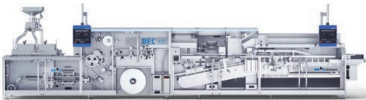
Figure 142 : Exemple de blistéreuse automatique Uhlmann B1330[175].
