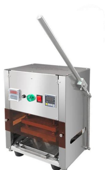
Figure 138 : Blistérisation manuelle par collage avec le système Medi-Dose[170], [171].
