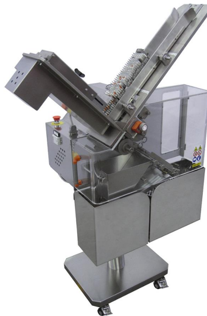
Figure 137 : Exemple de déblistéreuse automatique à rouleau : O.M.A.R. F160[169].
