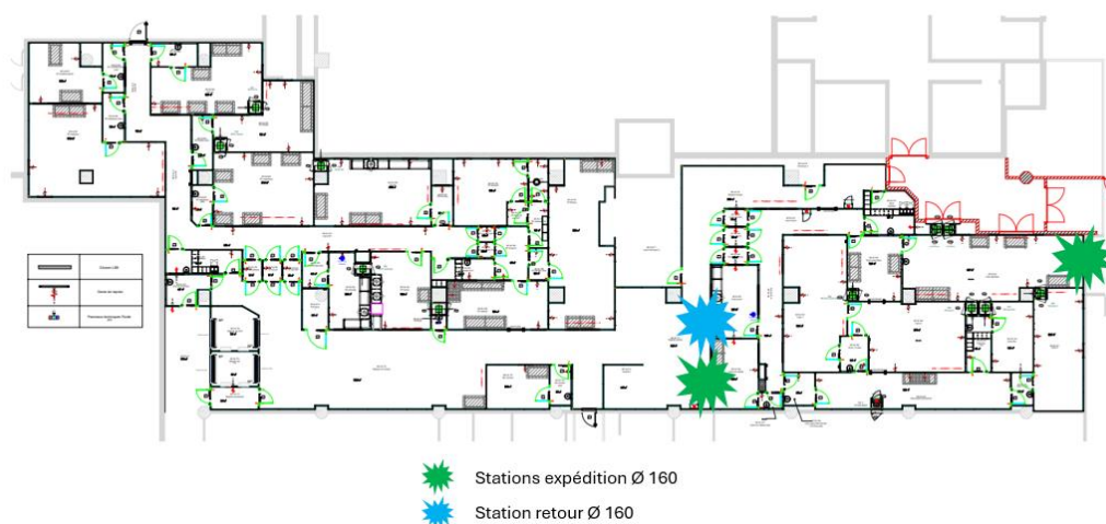
Figure 110 : Implémentation des stations de pneumatique Ø160 dans la zone de production de la pharmacie du CHU de Liège.
