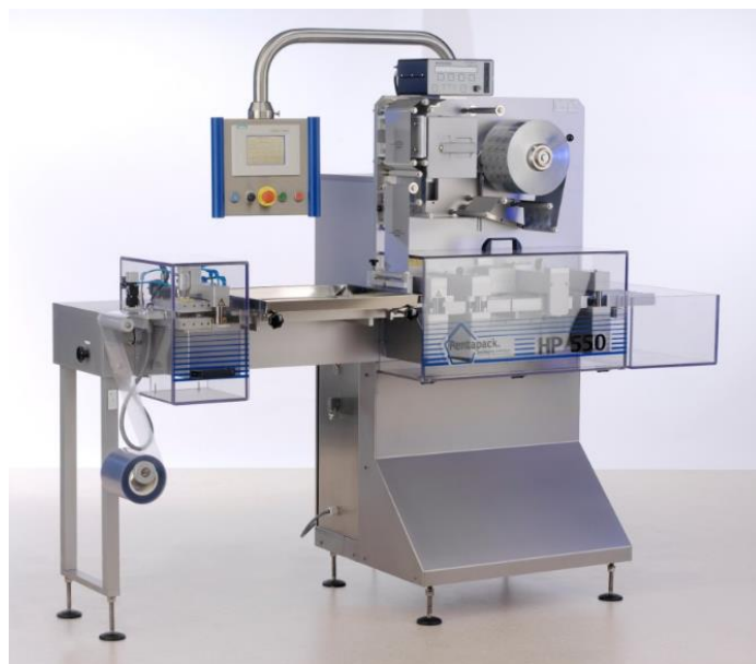
Figure 141 : Exemple de blistéreuse semi-automatique Pentapack HP 550[174].
