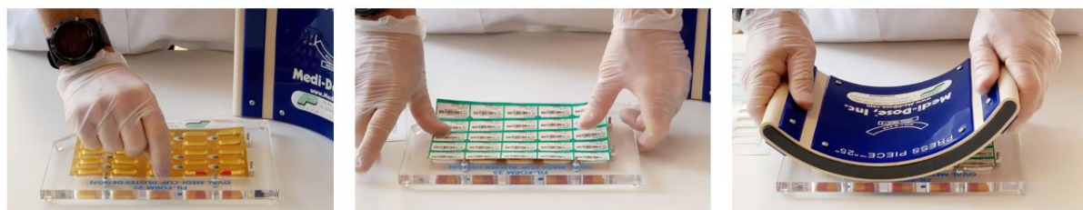
Figure 138 : Blistérisation manuelle par collage avec le système Medi-Dose[170], [171].
