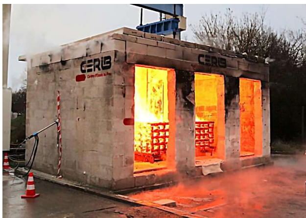
Fig. 5 : Essai dans un compartiment avec charge au feu en bois.
