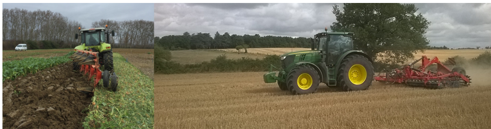
FIGURE 1.1 – Deux exemples de gestions de résidus de cultures différents : à gauche le labour d'un couvert d'interculture préalablement broyé, à droite le déchaumage de chaumes de céréales.
