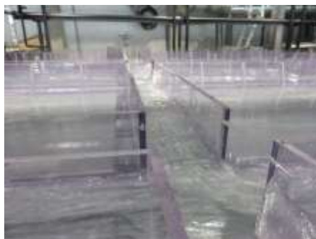
Modélisation expérimentale d'une inondation dans un réseau de rues (thèse de Mejia 2022)
