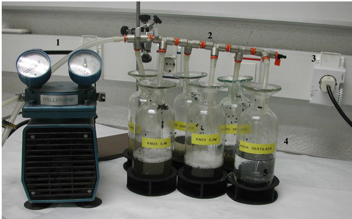
Fig. 4. Sistema de acondicionamiento osmótico: 1, bomba de aire; 2, sistema de conexiones múltiples; 3, temporizador, 4, recipientes cóncavos de acondicionamiento osmótico y 5, micropipeta pastor por donde llega el aire en el medio de acondicionamiento.
