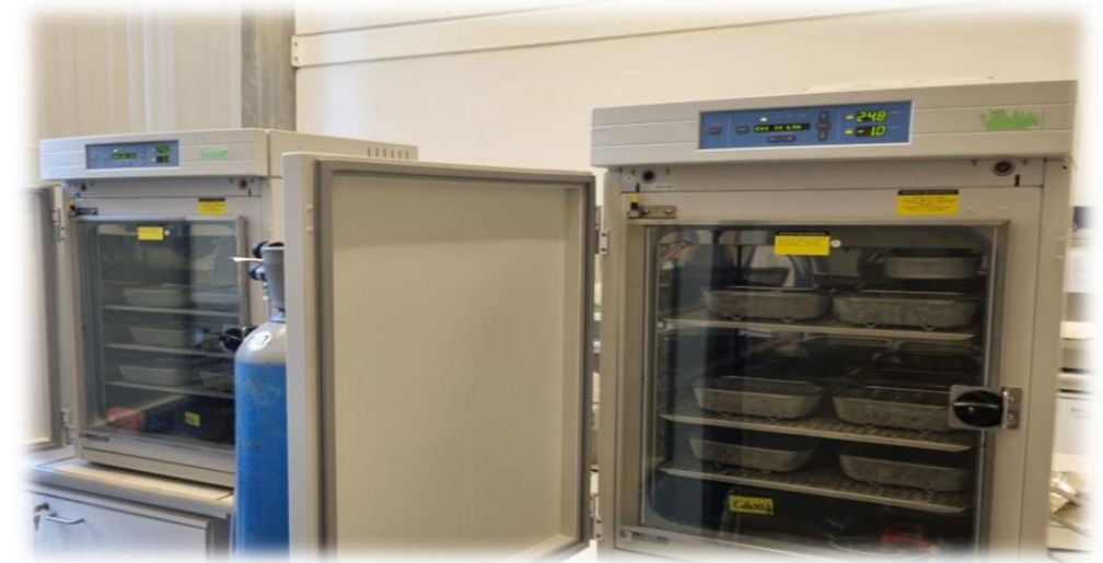
Chambre de carbonatation statique
