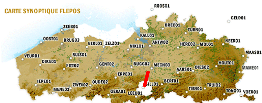
Figure 5.5. Localisation de la ligne de base MECH-GILL sur le réseau FLEPOS ( \approx 20.5 km) (Source : Site de l'IGN 1 )
