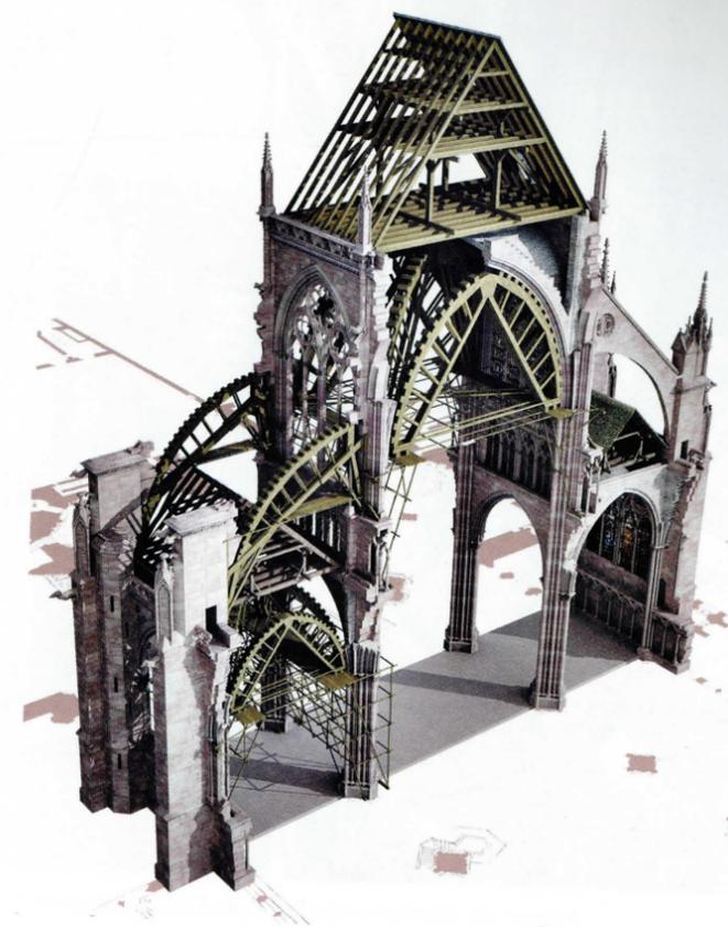
Figure 17. Restitution de la deuxième travée est de la nef et du principe d'échafaudage. Cette image ne respecte pas la chronologie de construction, mais montre la partie sud terminée et la partie nord avec son système de cintrage et d'échafaudage.
