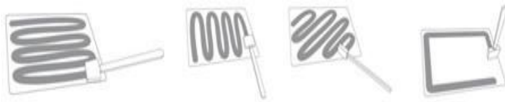
Figure 2. Méthode d'échantillonnage des surfaces. Les échantillons sont prélevés par des mouvements horizontaux, verticaux et diagonaux, et sur les bords. (Lahou et Uyttendaele, 2014).
