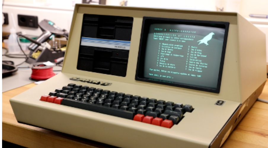
Ordinateur Smaky 6 (1978–1982) — boîtier beige muni de deux lecteurs de disquettes et d'un moniteur — en fonctionnement avec un disque de jeux et démonstrations. Photo prise par le professeur Yannick Rochat dans notre laboratoire, le 24 octobre 2023. (Avec l'aimable autorisation de l'auteur.)
