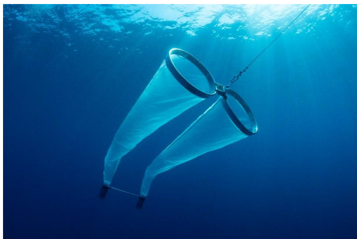
Filet Bongo de KC Denmark tracté par le STARESO.
