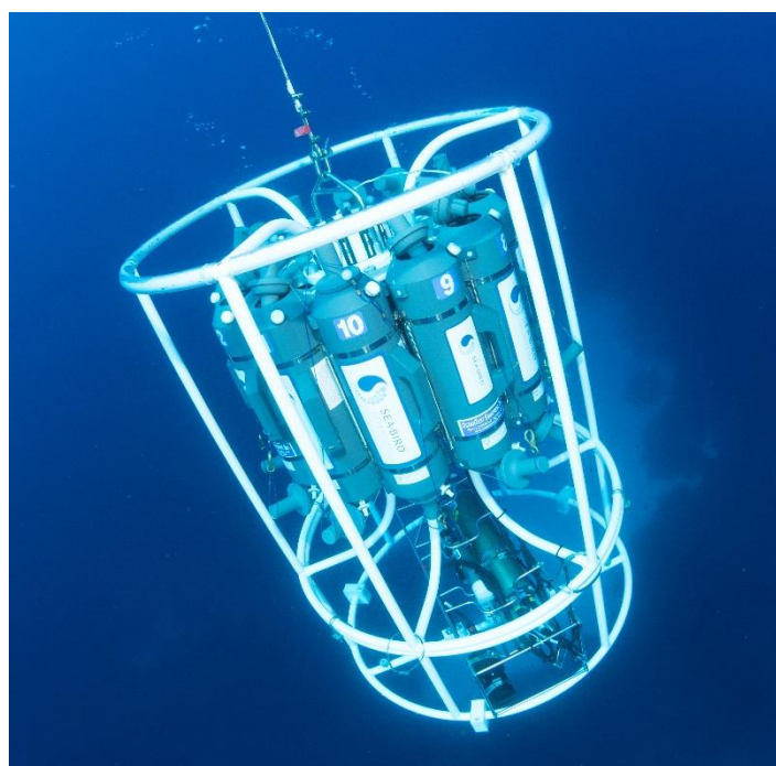
Rosette portant 12 bouteilles Niskins de 5 L, avec une interface électronique en son centre (SEA-BIRD SCIENTIFIC).
