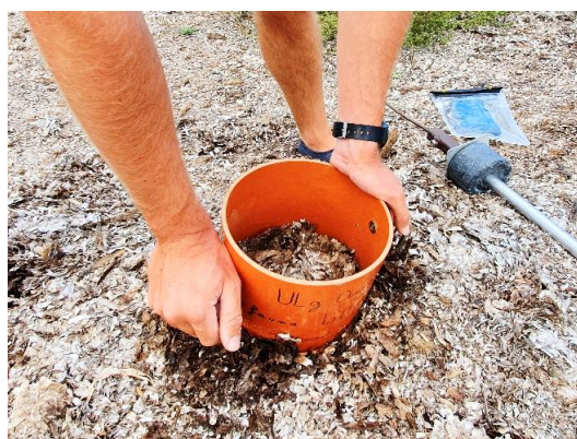
Mesures géoréférencées de l'épaisseur (A) et de la compacité (B) à l'aide d'un compaciteur.
