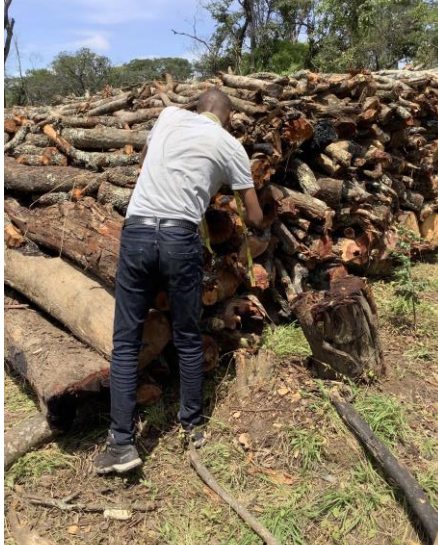
Figure 3-6 : Prélèvement du taux d'humidité et du diamètre des bois utilisés pour la carbonisation au village Sela.
