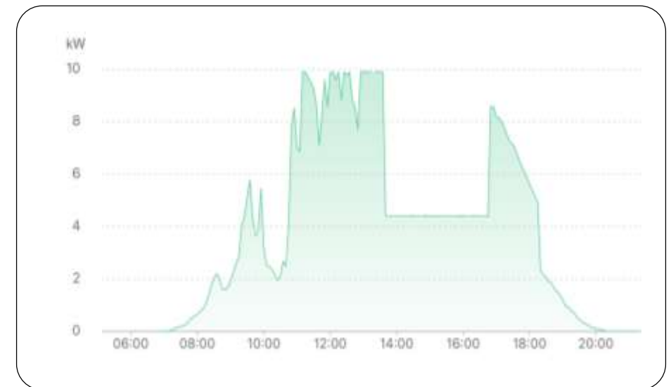
Courbe de production d'une installation PV équipée de deux onduleurs. Peu avant 14h, l'un des deux se déconnecte.
