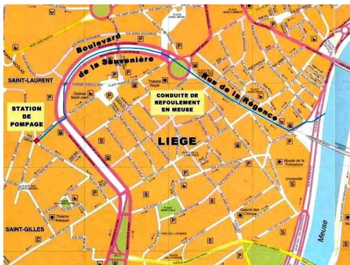
Figure 36. Canalisation des eaux d'exhaure via le réseau d'égouttage existant
