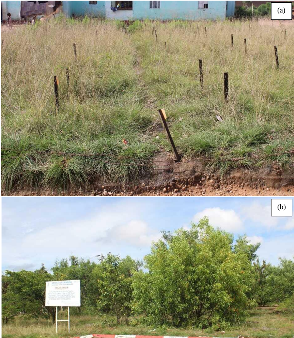
Figure 2-4. Essais de phytostabilisation sur des sols dénudés dans le quartier Penga Penga : (a) essai avec des graminées et (b) essai avec espèces ligneuses
