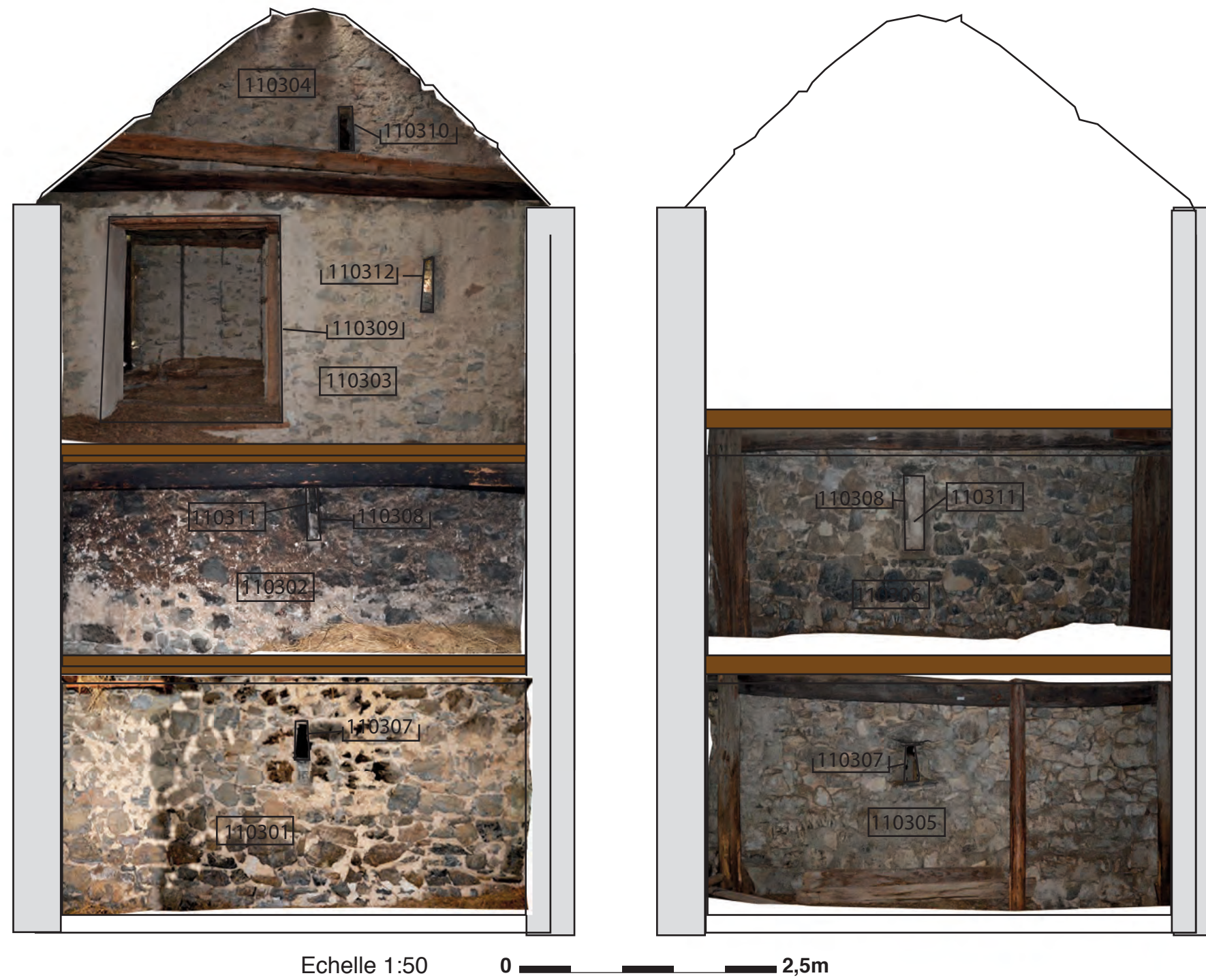
MR 1103, Croquis stratigraphique du parement sud. Dessin de V. Labbas, 2012
