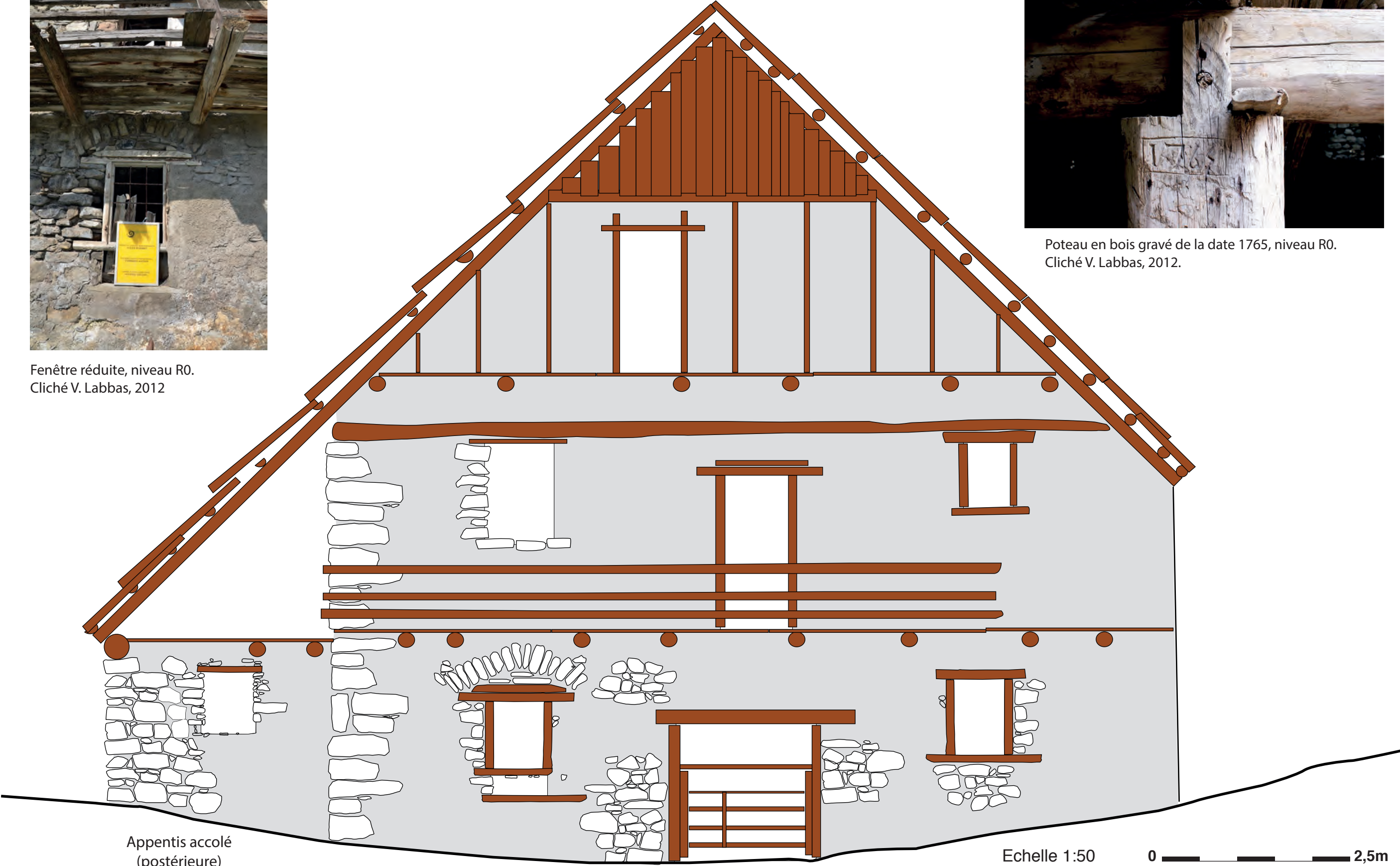
Champ Richard (Allos, 04), bâtiment CR 100 : Croquis de la façade sud, échelle: 1/50e Dessins V. Labbas, 2012
