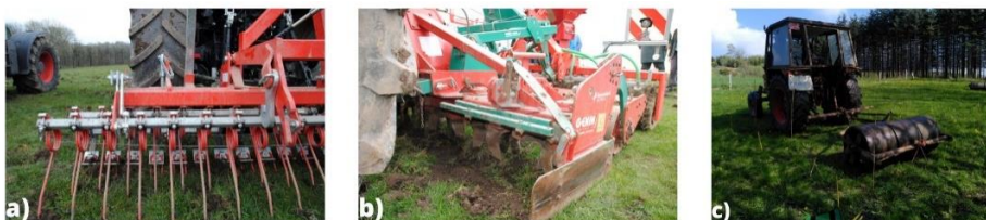
Figure 1 : Herse étrille (a), herse rotative (b) et rouleau (c)
