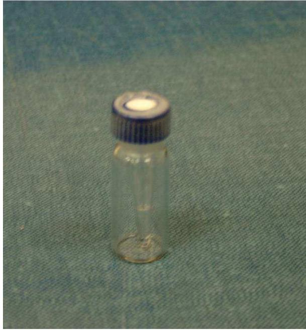
**Figure 23: Insert placé dans un vial utilisé pour récolter le produit de l'élution**
