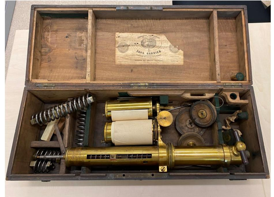
Indicateur de pression de type Garnier (largeur du papier : 10,3 mm).
