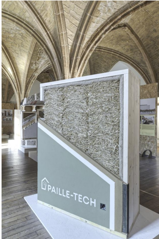
Pailletech : ossature bois, isolant en paille, enduit terre
