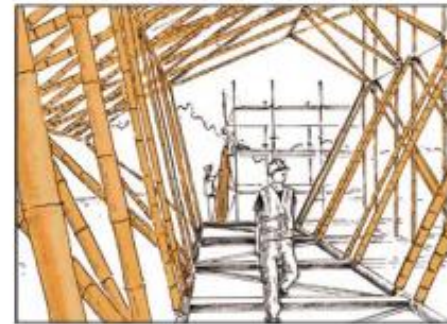
LE PROJET EST CONSTITUÉ DE 1 400 TIGES DE BAMBOU DE 3 À 10 MÈTRES DE LONGUEUR.
