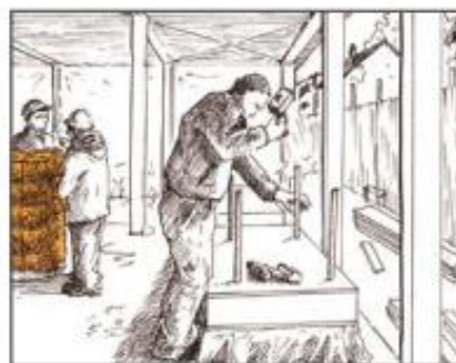
UNE LISSE BASSE EN BOIS MASSIF EST FIXÉE SUR LE SOUBASSEMENT ET LA BARRIÈRE D'ÉTANCHÉITÉ POUR RÉALISER LE DÉPART DES MURS.
