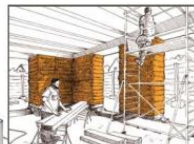
LES BOTTES SONT MAINTENUES PAR COMPRESSION ENTRE LA LISSE HAUTE ET LA LISSE BASSE. LA TOITURE EST POSÉE DIRECTEMENT SUR LES MURS.
