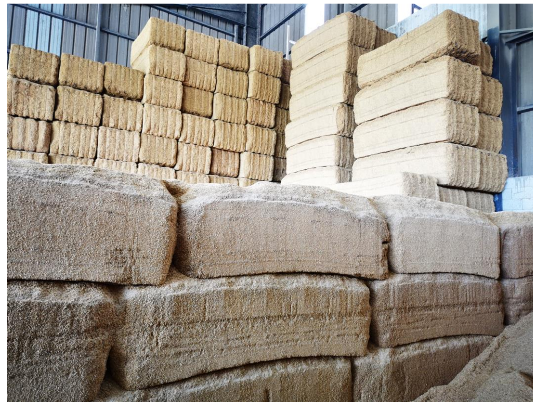
Valorisées sous forme d'isolant thermique Avoine - \lambda de 0,065 W/mK Riz - \lambda entre 0,049 et 0,052 W/mK
