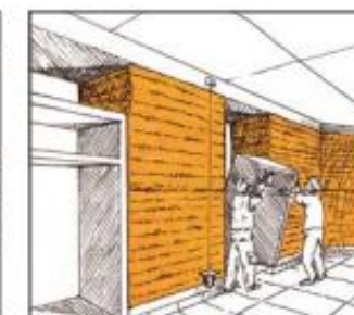
DES PRÉ-CADRES SONT MIS EN PLACE AVANT LA POSE DES MENUISERIES EXTÉRIEURES. LA COMPRESSION DE LA PAILLE EST CONTRÔLÉE EN DIFFÉRENTS POINTS À L'AIDE DU FIL À PLOMB.
