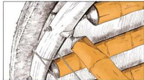
POUR LIMITER LA DÉTÉRIORATION DES ÉLÉMENTS LORS DU SERRAGE ET TRANSMETTRE AU MIEUX LES EFFORTS MÉCANIQUES, DES COUPELLES MOULÉES EN ALUMINIUM RÉCYCLÉ SONT INTERCALÉES DANS L'ASSEMBLAGE PAR TIGE FILETÉE.
