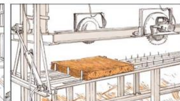
LES PANNEAUX DE BARDAGE EN ROSEAU SONT PRÉPARÉS EN ATELIER À L'AIDE D'UNE MACHINE FABRIQUÉE SPÉCIALEMENT POUR LE CHANTIER, QUI MET AU GABARIT ET COUPE LES ROSEAUX AUX DIMENSIONS DU CALEPINAGE.
