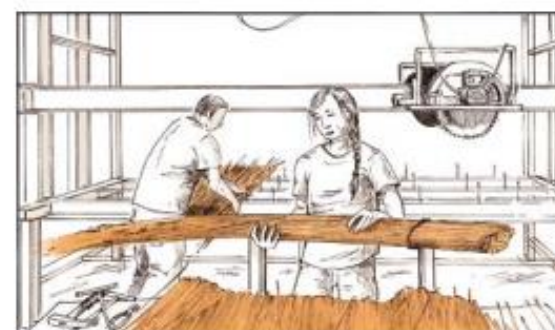
LES PANNEAUX DE BARDAGE EN ROSEAU SONT PRÉPARÉS EN ATELIER À L'AIDE D'UNE MACHINE FABRIQUÉE SPÉCIALEMENT POUR LE CHANTIER, QUI MET AU GABARIT ET COUPE LES ROSEAUX AUX DIMENSIONS DU CALEPINAGE.
