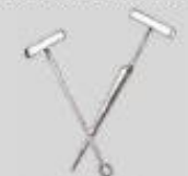
Les aiguilles sont utilisées pour faire passer la ligature autour du chaume et le presser entre la barre et le support.
