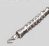
Le vriilleur permet au chaumier de serrer fortement les fils d'attache.
