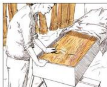
LES BRINS D'OSIER ÉCORCÉS SONT TREMPÉS DANS UN BAIN D'EAU FROIDE AFIN DE LES ASSOPLIR.
