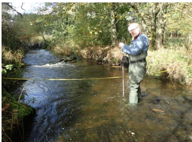
Figure 5 Opérateur en train de réaliser un jaugeage à la sonde électromagnétique
