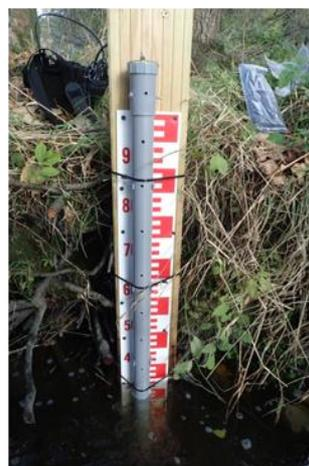
Figure 6 Échelle limnigraphique installée sur site avec dispositif contenant le TD-Diver™
