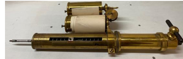
Garnier-type engine indicator (largeur du papier : 10,3 mm). Laboratoire de Thermodynamique de l'Université de Liège. Photos par l'auteur (Août 2023 et Novembre 2021).
