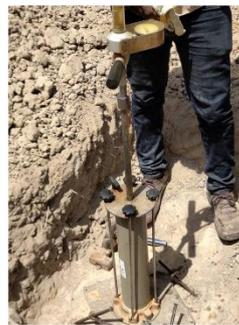
Mesure de  $D_a$ : méthode au densitomètre
