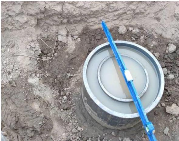
Photo 3: Dispositif de mesure de la conductivité à saturation  $K_s$  à l'aide du double anneau de Muntz
