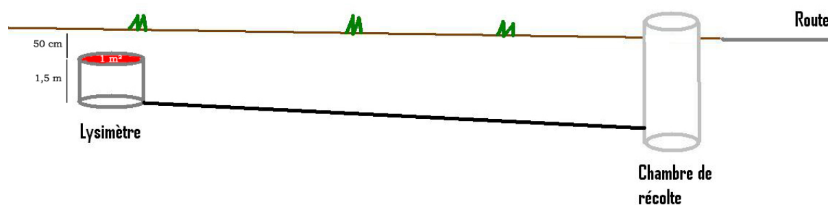
Figure 1. Coupe d'un dispositif lysimétrique (Vandenberghe et al., 2021).
