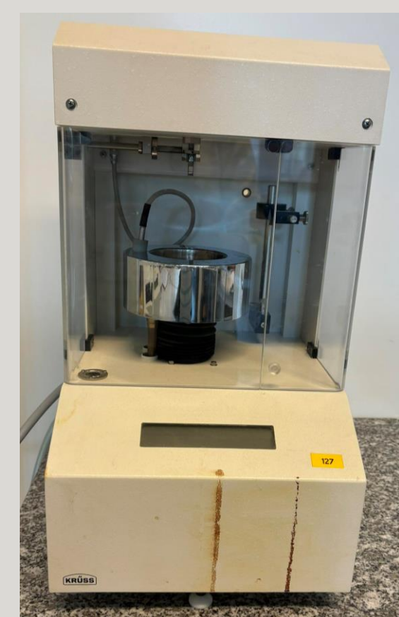
Fig 2 – Tensiomètre et schéma du principe
