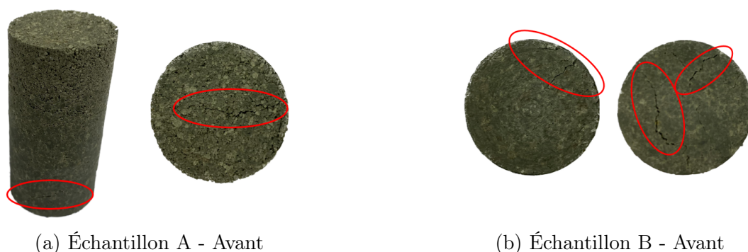
FIGURE 5.12 – Aspect visuel des échantillons de Tournai avant l'essai de compression simple
