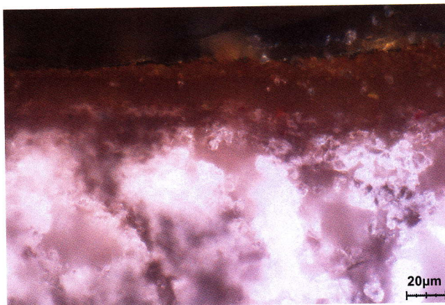
Vue en coupe avec lumière polarisée, dorure verte 1902, travée 2 (© IRPA-KIK Bruxelles)
