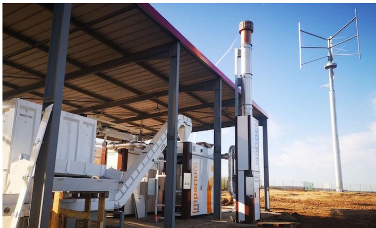
Figure 57 : centrale pilote de gazéification des déchets verts à Audun-le-Tiche (CCPHVA) (Douard, 2021)
