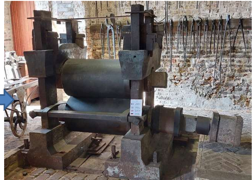
Laminage pour aplatir le lingot en plaque ou en tôle
