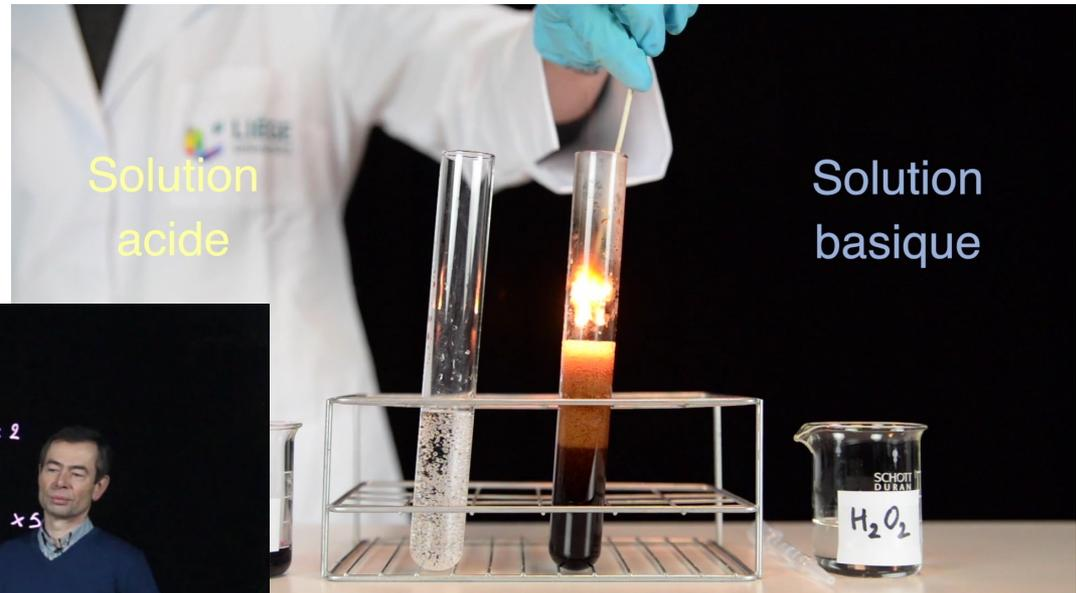
$$\text{MnO}_4^- + \text{H}_2\text{O}_2 \longrightarrow \text{Mn}^{2+} + \text{O}_2$$
