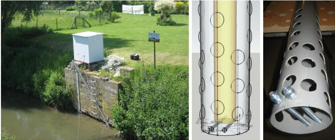
Fig. 6-24. Installation de la cabine à équipement et du support de sonde (mai 2010).
