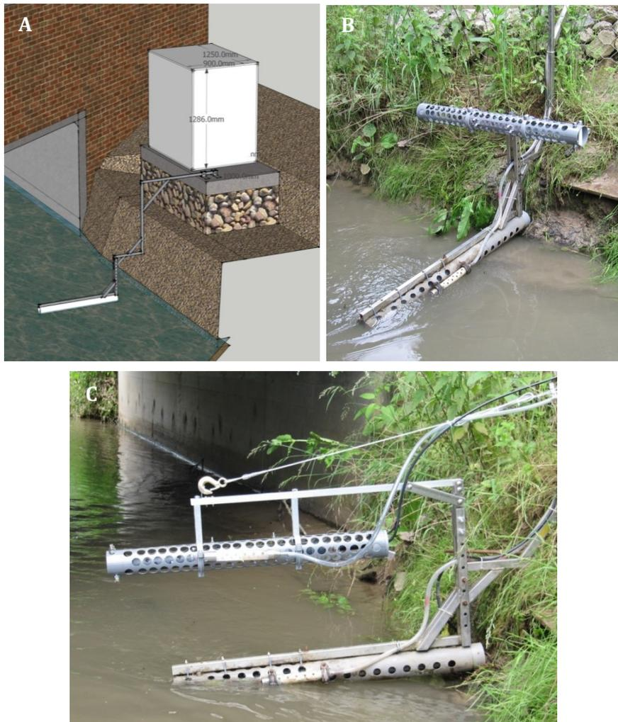
**Fig. 6-27. A. Conception tridimensionnelle du bras mécanique qui supportera la sonde de turbidité. B et C : deux possibilités de fixation de la seconde sonde : parallèle ou perpendiculaire au courant (juin 2012).**
