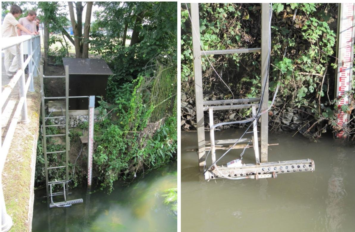
**Fig. 6-23. Installation du dispositif mécanique à Florival. Mise en place de la sonde et de la crépine de prélèvement sur le chariot (15/07/2011). Installation du système de nettoyage du capteur par air comprimé (alimentation par batterie, été 2012).**
