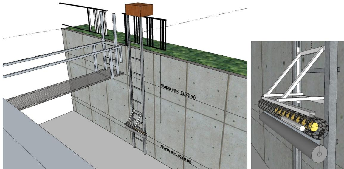
**Fig. 6-82. Plan conceptuel de l'échelle et du chariot mobile (avec un tube pour la sonde et un second tube pour un éventuel échantillonneur TIS - Time Integrated Sampler).**
