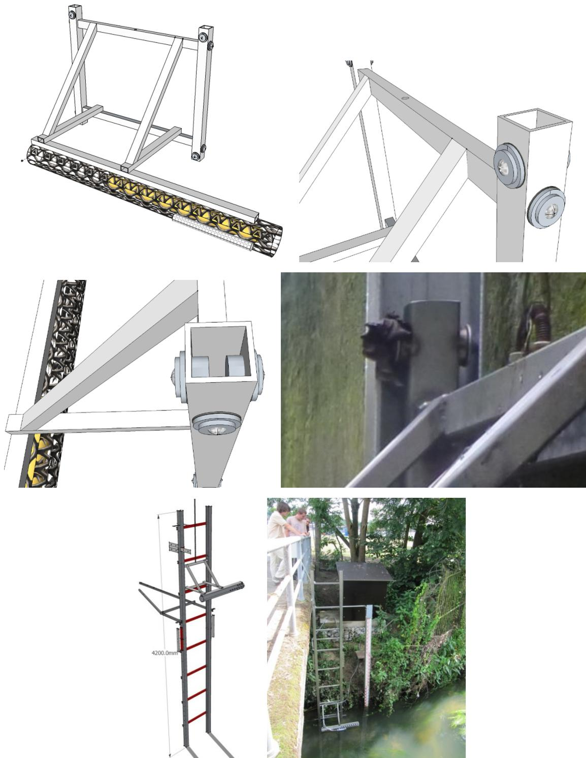
**Fig. 6-85. Plan conceptuel et vue réelle sur les roulements à billes facilitant le glissement et limitant l'encrassement.**
