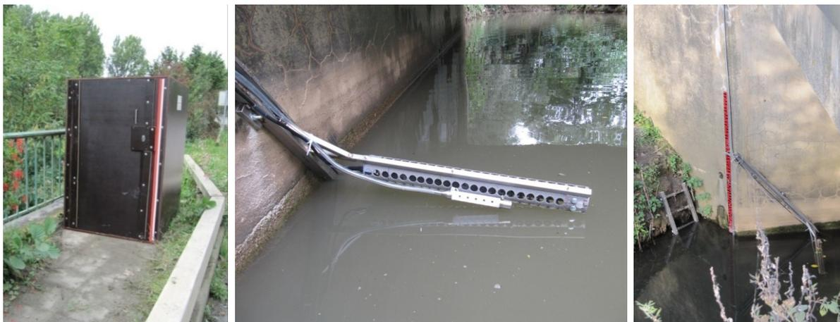
**Fig. 6-20. Cabine, sonde turbidimétrique et crépine de prélèvement perpendiculaire au courant et vue d'ensemble (09/09/2011).**
