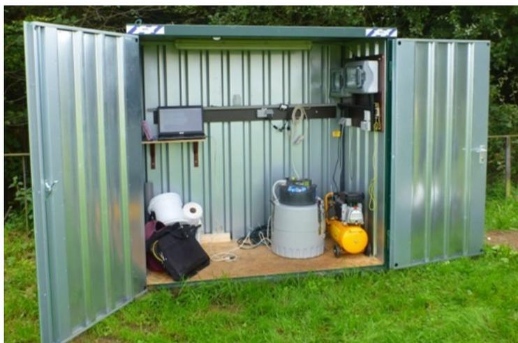
**Fig. 6-81. Cabine de chantier métallique alimentée électriquement et disposant d'un échantillonneur ISCO et d'un compresseur à réservoir.**
