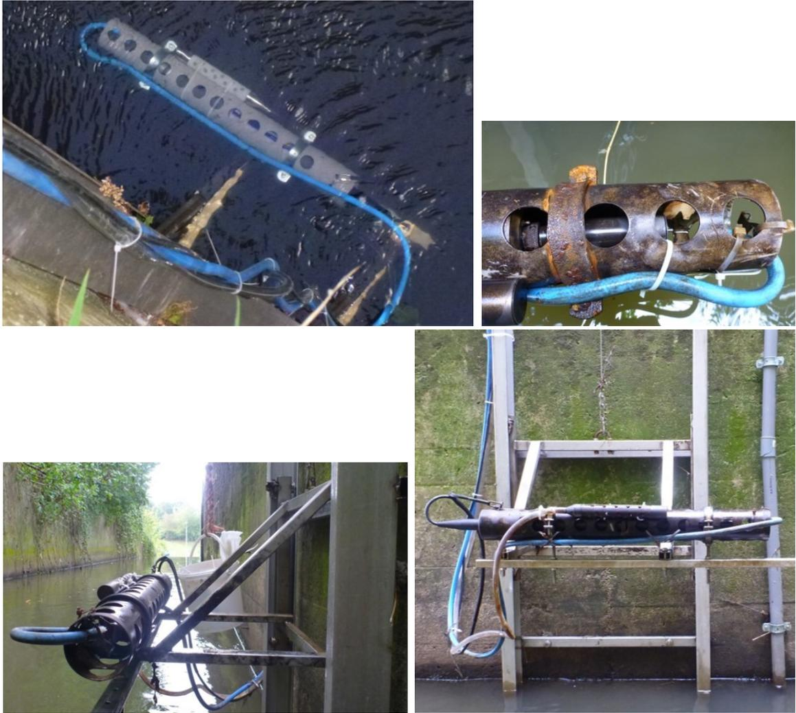
**Fig. 6-84. Gros plan sur le chariot mobile contenant la sonde, pointée vers l'amont, et la buse injectant l'air comprimé en direction de la fenêtre optique du capteur de turbidité.**
