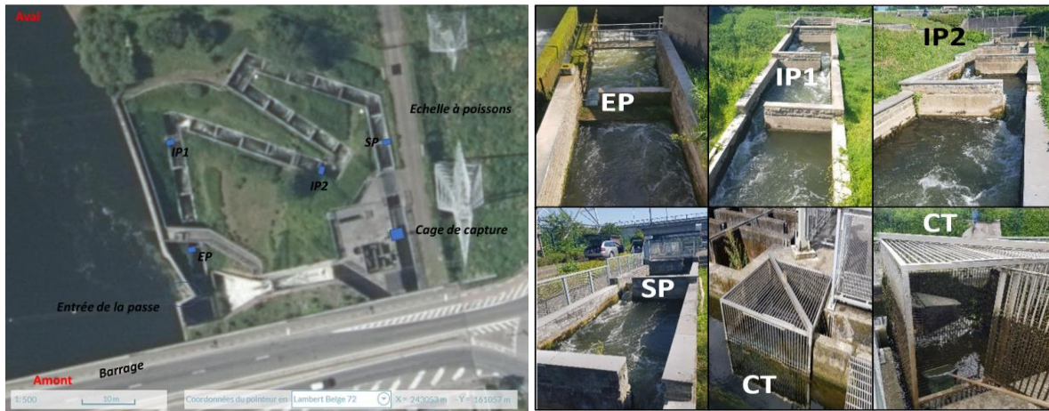
Figure 8 : Site d'étude du barrage de Lixhe avec les 4 antennes RFID, la cage de capture et le lieu de déversement ( à gauche, source : Walonmap) et les 2 Antennes RFID (EP=Entrée Passe ; SP=Sortie Passe) et la cage de capture (à droite).
