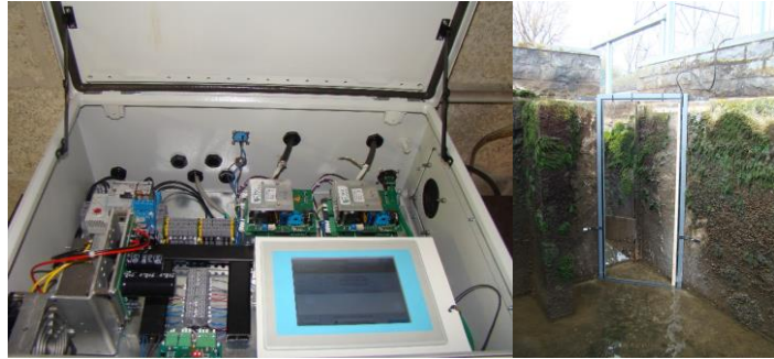
Figure 3 : Station d'enregistrement RFID automatique (à gauche) et antenne de détection (à droite)
