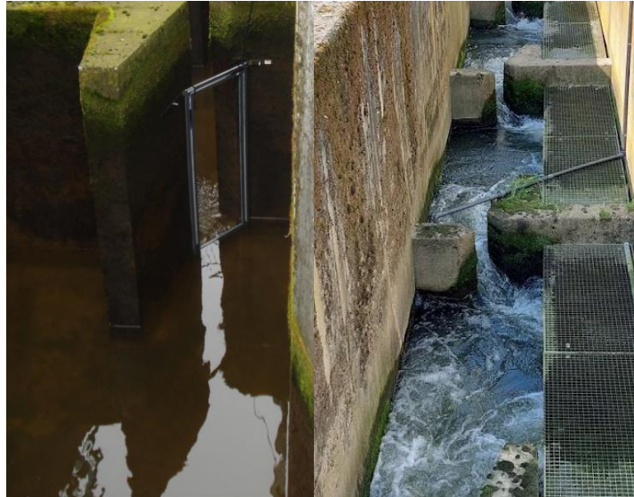
Figure 6 : Antennes de détection automatique RFID installée au sein de la passe à poissons du barrage d'Ivoz-Ramet (amont à gauche, aval à droite).
