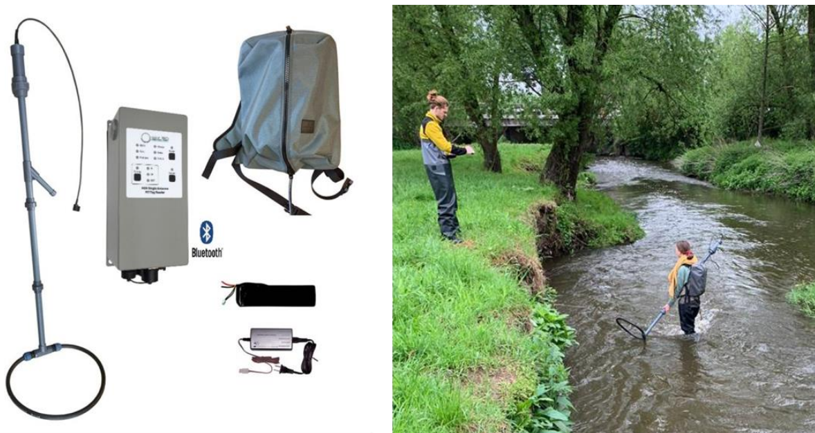
Figure 12 Antenne Oregon ( www.oregonrfid.com ) (gauche) et Suivi RFID manuel dans la Berwinne (à droite)
