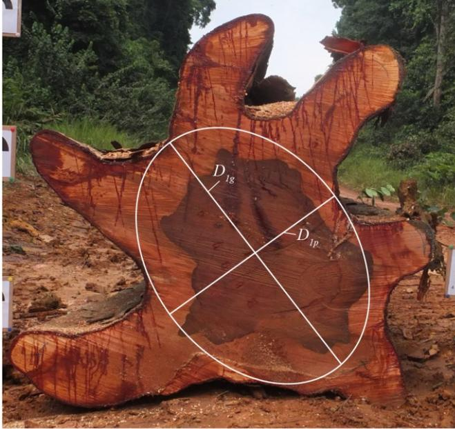
Figure 68 : Méthode de mesure dite “sous les cannelures” de *S. mannii* du plus grand diamètre de la première face de la bille ( $D_{1g}$ ) et du plus petit diamètre perpendiculaire ( $D_{1p}$ ).
