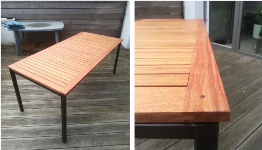
Figure 60: Table extérieur en *Dialium polyanthum* selon une mise en œuvre appropriée. Seul des pièces sur quartier/faux quartier ont été utilisées. Les traverses intérieur sont espacées et uniquement vissées dans la rainure du montant pour laisser le retrait radiale s'exprimer (Namur, Belgique).
