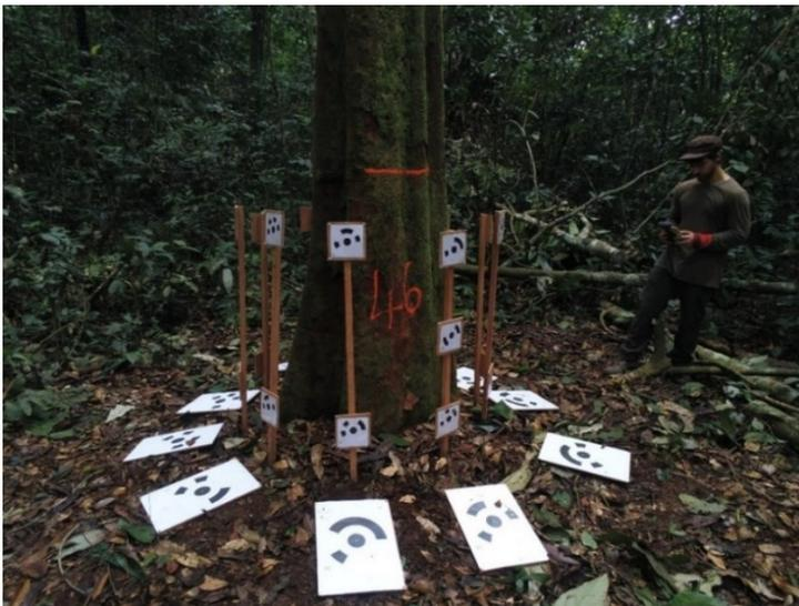
Figure 65 : Position des cibles de références. Le centre des deux cibles en premier plan a été placé à exactement 50 cm de distance.
