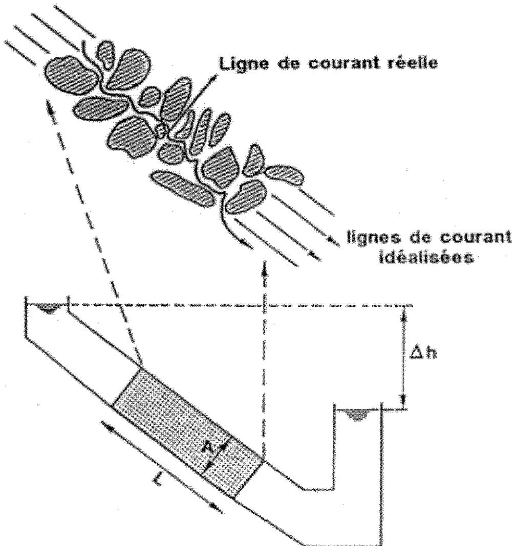
**Fig.VI.1 Ecoulement à travers un échantillon poreux.**
