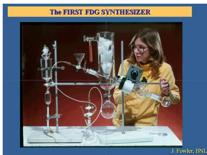
Figure i.3a Le premier synthétiseur de [ ^{18}\text{F} ]FDG, 1978 [Ido 1978]
