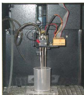
Figure 15-2. Cellule de pompage de l'Anadis AEGYS Mi 200
