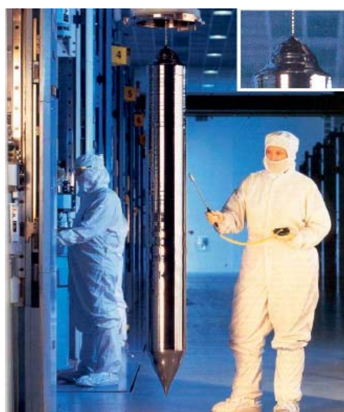
Figure A2 - 2 : Schéma de tirage d'un lingot de silicium monocristallin
