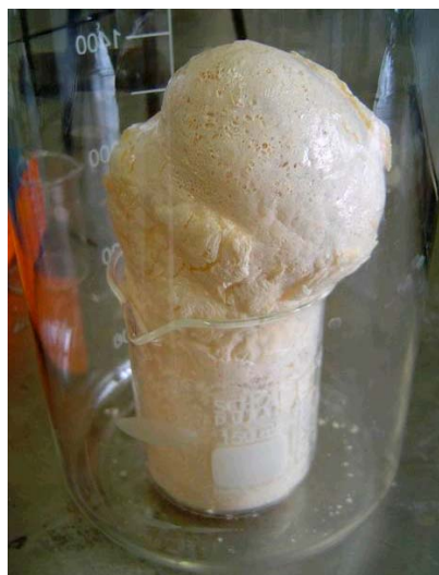
Figure IV - 4 : Photographie du polyester obtenu par la méthode Pechini après réaction dans une étuve préchauffée à 150°C
