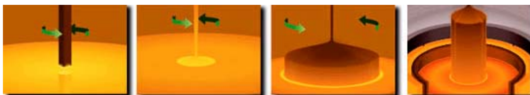
Figure A2 - 2 : Schéma de tirage d'un lingot de silicium monocristallin
