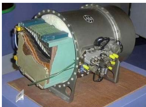
Figure I – 3 : Pile à combustible utilisée dans le vaisseau spatial Gemini 7, 1965
