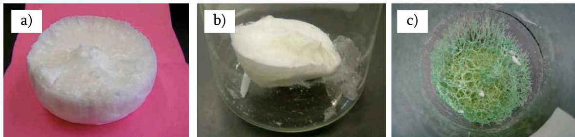
Figures VI - 4 : Photographies de cryogels obtenus depuis a) une solution de HPMC seule, b) et c) en présence de cations. La teneur en HPMC est de 20 g par kg de solvant pour a) et b) et de 10 g par kg de solvant pour c)
