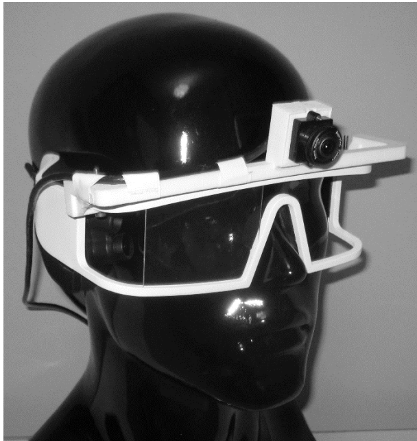
Figure 12 – Paire de lunettes portée par le sujet pour la mesure objective de la poursuite visuelle. La paire de lunettes disposait d'une caméra fish eye pour enregistrer la scène et donc les mouvements du miroir, et d'une caméra infrarouge qui enregistrerait les mouvements de l'œil droit via un miroir infrarouge, transparent dans la lumière visible. Illustration de l'article original [104].
