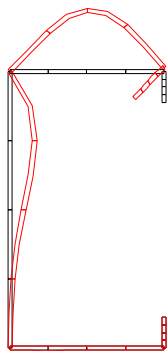
Point A: flambement local
